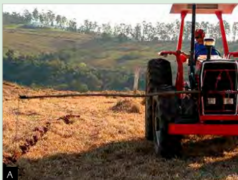
Figura 23: Uso de um pedaço de madeira com uma corrente em sua extremidade para a orientação da subsolagem em relação à linha adjacente (A) e disco de corte do subsolador cortando a palhada já seca (B).
